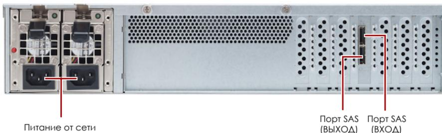
1. Выключите питание **системы** (главного модуля XS-серии и его модулей расширения).
