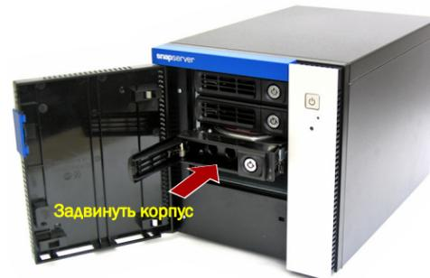
6. Закройте **ручку**, повернув ее до щелчка. Диск будет зафиксирован.
