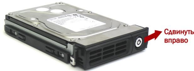
1. Сдвиньте **кнопку разблокировки** на корпусе вправо. Фиксатор на передней стороне корпуса разблокируется, и ручка выдвинется.
