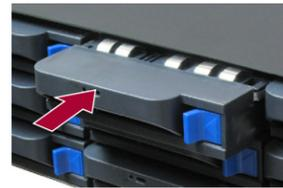
**ВАЖНО:** Чтобы обеспечить надлежащую вентиляцию и охлаждение, необходимо, чтобы в каждом слоте был установлен диск или пустой корпус. Нельзя оставлять слоты пустыми.
