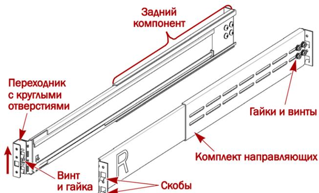
1. Определите место 2U там, где должен устанавливаться модуль, и пометьте **третье и пятое отверстия** с обеих сторон, спереди и сзади.
