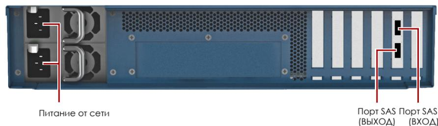
1. Выключите питание **системы** (главного модуля DX-серии и его модулей расширения).
