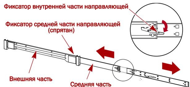
Рисунок 2. Фиксаторы внутренней направляющей
